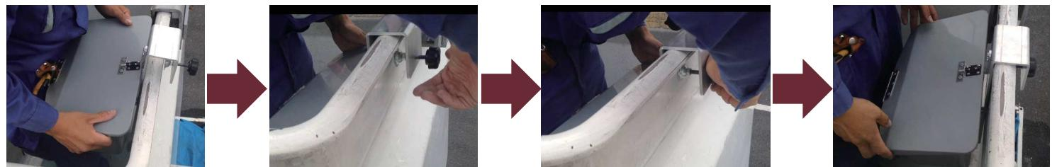
取り付けの様子。はめ込んでノブボルトで取り付ける構造になっています。
